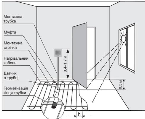
Рисунок 1. Монтаж терморегулятора і системи тепла підлога
