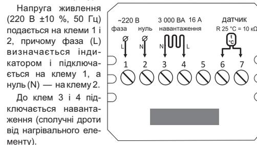
Схема 1. Схема підключення і спрощена внутрішня схема
