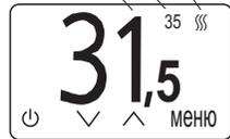
Натисніть та утримуйте ліву кнопку протягом 5 с. Після вимкнення терморегулятор перейде в сплячий режим. Для повного вимкнення при тривалій перерві у використанні необхідно вимкнути автоматичний вимикач в щитку.
