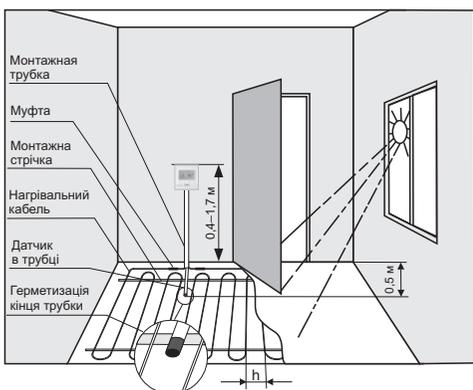
Рисунок 1. Монтаж терморегулятора та системи тепла підлога
