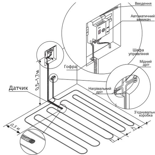
Рисунок 1. Монтаж терморегулятора і системи «тепла підлога».
