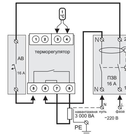
Схема 2. Підключення автоматичного вимикача і ПЗВ
