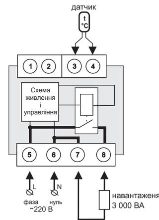
Схема 1. Спрощена внутрішня схема і схема підключення
