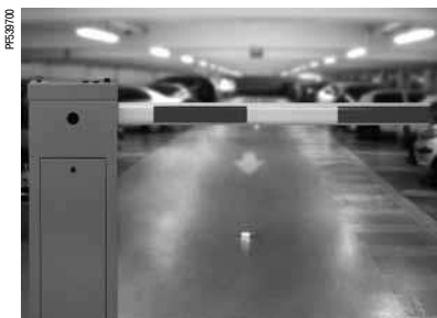
Шлагбаум, управляемый ПЧ ATV 12
