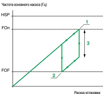
Работа основного и вспомогательного насосов: гистерезис
